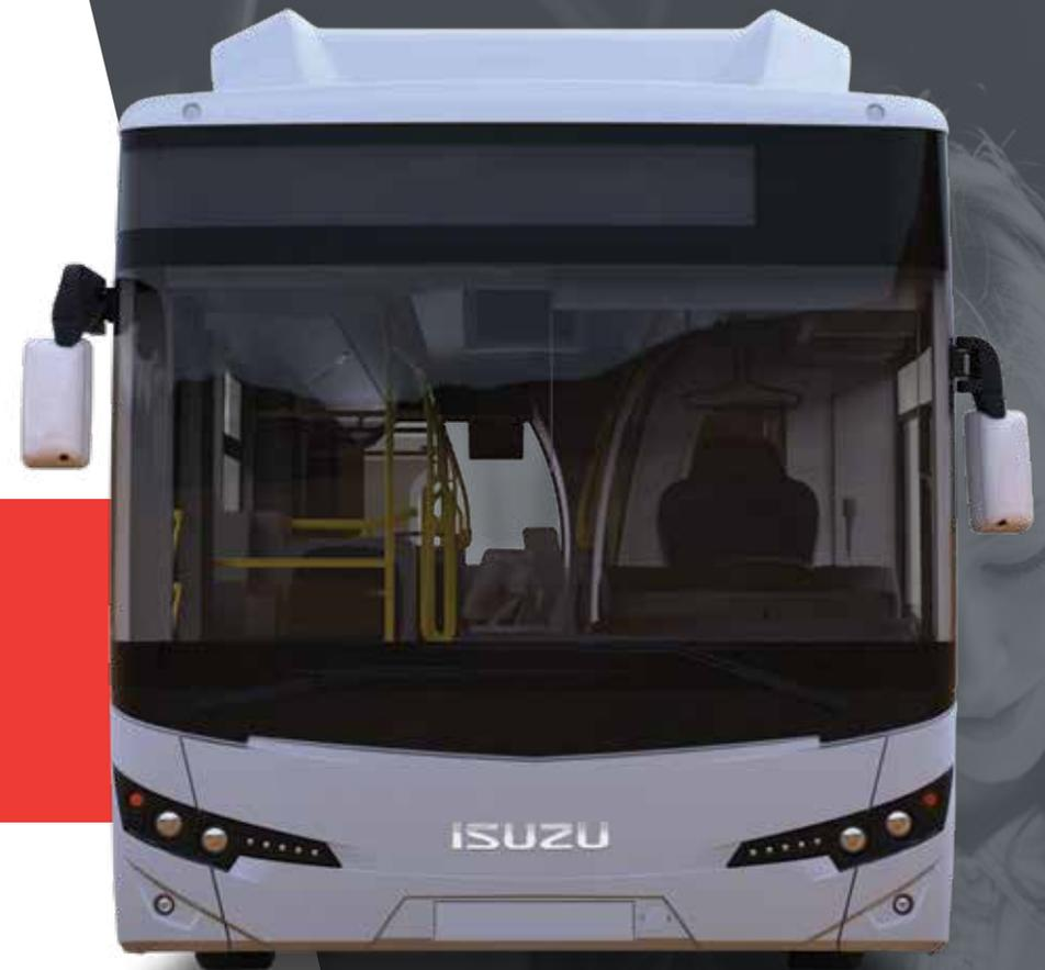
Citipoint también ofrece una solución de transporte verde. La versión CNG de Citipoint 12 está disponible con motor Cummins que produce 320 PS y 1357 NM de torque. La transmisión automática completa de ZF Ecolife se ofrece como estándar. Los clientes pueden seleccionar una de dos opciones de tanque de gas: tanques de gas tipo 3 con 5 unidades (volumen total de 1470 LT) o tanques de gas tipo 4 con 5 unidades (volumen total de 1175 LT).
